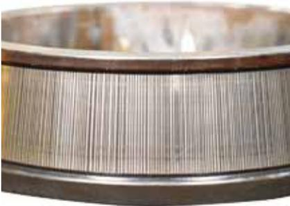
Fig. 37: Electric Corrosion
